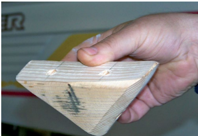
Fig. 24. Viser V-kilen som sikrer et godt mothold inne i båten.
