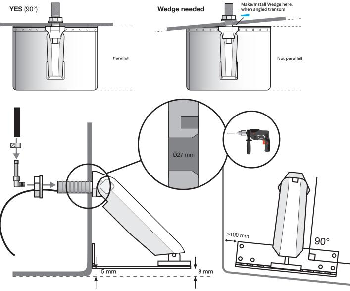
Vinkel mellan cylinder och skivan måste vara 90°. The angle between the cylinder and the plate must be 90°.
