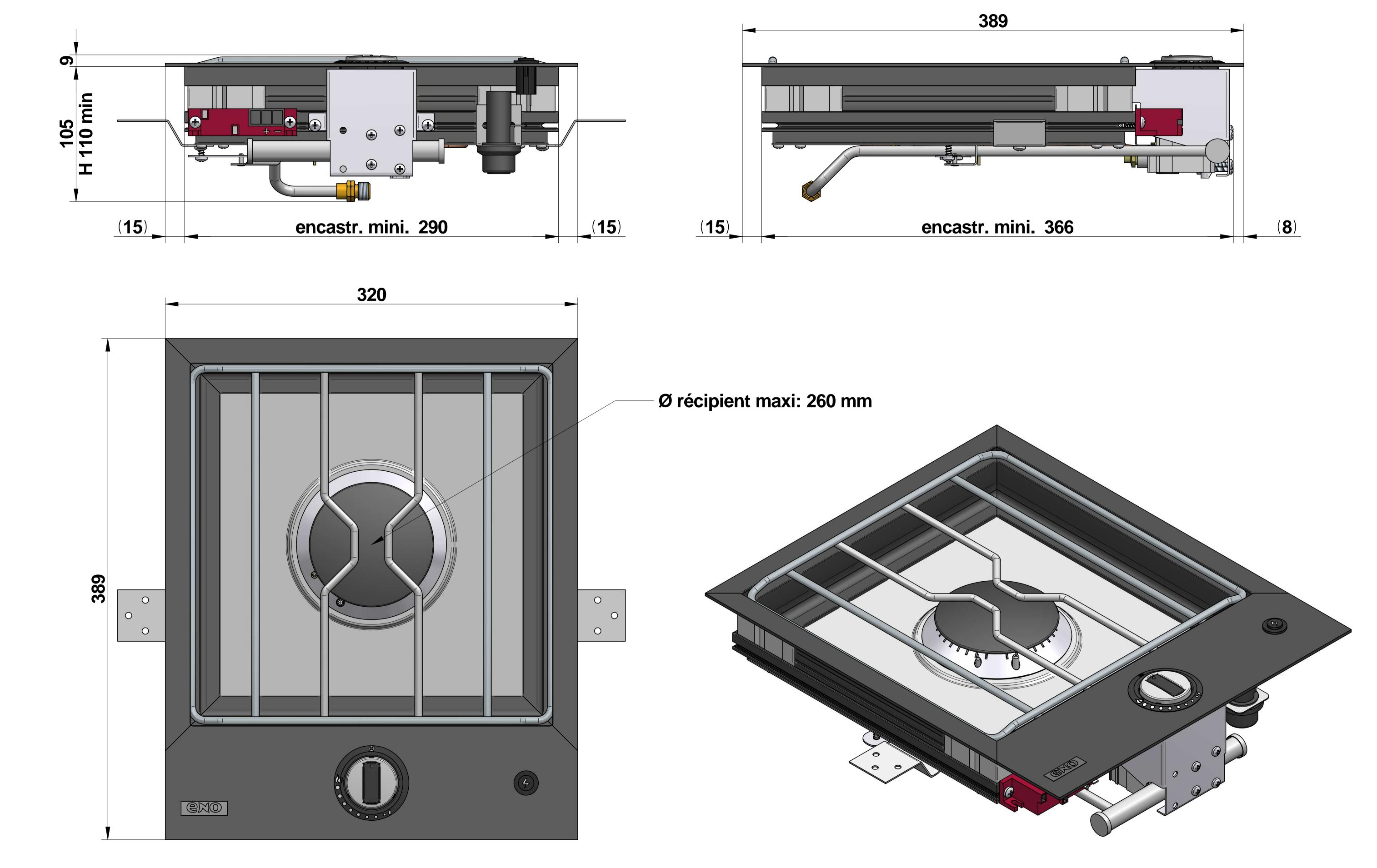
Product dimensions / Dimensions produit (H / L / P) : 110 x 320 x 390 mm Built—in dimensions / Dimensions d'encastrement (L / P) : 305 x 380 mm
