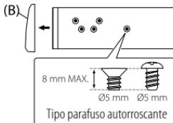
⚠ Utilize apenas os parafusos especificados. Utilizar parafusos inadequados pode danificar o aparelho.
