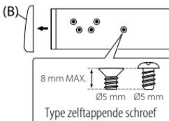
⚠ Gebruik alleen de gespecificeerde schroeven. Het gebruik van verkeerde schroeven kan het toestel beschadigen.
