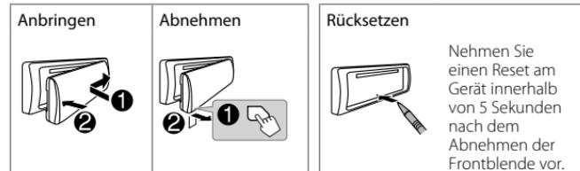
Nehmen Sie einen Reset am Gerät innerhalb von 5 Sekunden nach dem Abnehmen der Frontblende vor.
