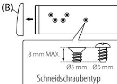
⚠ Verwenden Sie nur die vorgeschriebenen Schrauben. Durch Verwendung falscher Schrauben kann das Gerät beschädigt werden.
