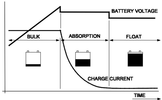
Curva de carga de tres etapas. Fase A: BULK, para carga rápida del 0 al 80%, Fase B: ABSORPCIÓN, la batería se carga del 80 al 100%. Fase C: FLOTACIÓN, la batería se mantiene en estado de carga total.
