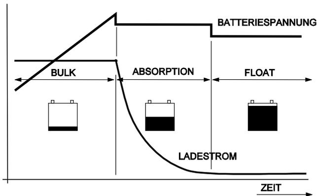
Ladekurve in 3 Stufen: A ist die Hauptladung (Bulk), B ist die Ausgleichladung (Absorption), in der die Batterien von 80 auf 100% geladen werden, und C ist die Erhaltungsladung (Float).
