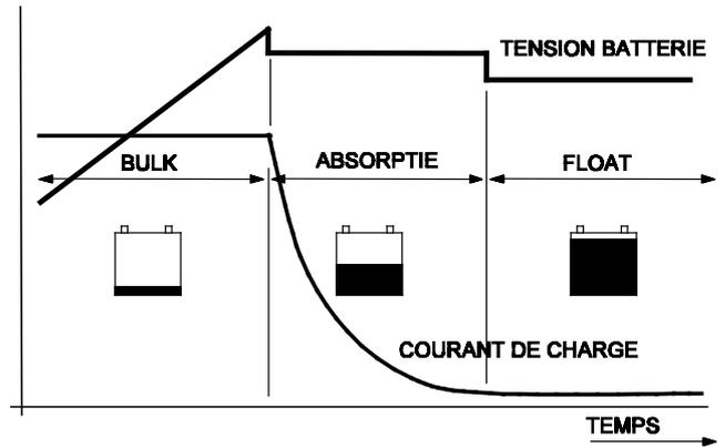
Courbe de charge à 3 étapes. Etape A : Bulk, la batterie est chargée rapidement, jusqu'à 80% environ. Etape B : Absorption, la batterie est chargée de 80-100%. Etape C : Float, la charge de la batterie est maintenue à 100%
