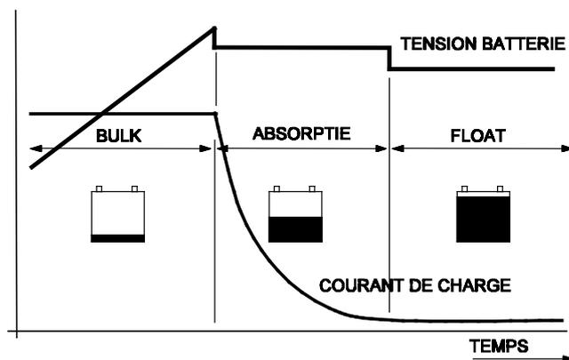
La curva di carica a 3 stadi. Lo stadio A: Bulk è per la carica veloce da 0 all'80%; lo stadio B Absorption, la batteria è caricata dall'80% al 100%; Stadio C: Float, la batteria è mantenuta nello stato di piena carica.
