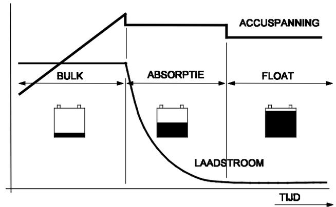
Drie-Traps laadkurve: Fase A is Bulk (snelladen). Fase B is Absorption, waarin de accu van 80 tot 100% geladen wordt. Fase C is de onderhoudsfase (Float).
