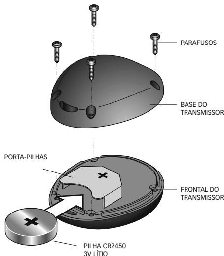
**ATENÇÃO:** verificar, depois que o transmissor estiver montado, se o indicador luminoso permanece constantemente aceso. Se o indicador luminoso abrir novamente o transmissor e verificar a sua correcta montagem.
