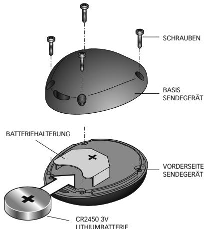
**ACHTUNG:** Prüfen Sie, dass nach dem erneuten Zusammenbau des Sendegeräts die LED nicht dauerhaft eingeschaltet bleibt. Sollte die LED eingeschaltet sein, öffnen Sie das Sendegerät erneut und prüfen Sie die Richtigkeit des Zusammenbaus.
