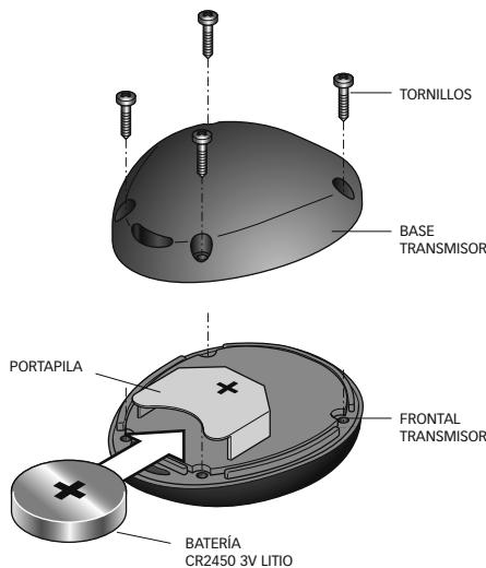
**ATENCIÓN:** después de ensamblar el transmisor, controlar que el LED no permanezca constantemente encendido. Si el led está encendido abrir de nuevo el transmisor y controlar el correcto ensamblaje.
